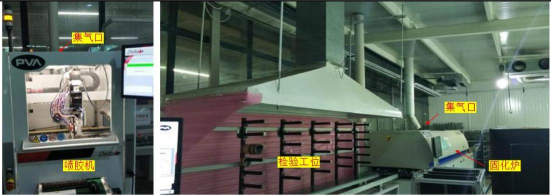
图8 喷胶、固化设备及集气方式示意图
