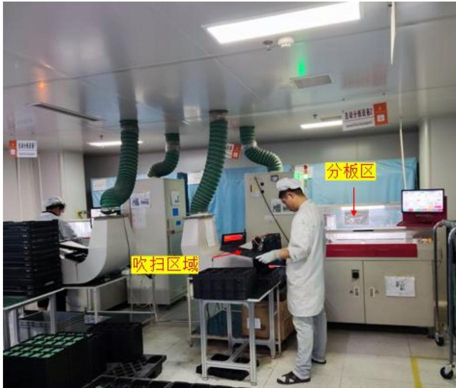
图 5 分板设备及集气方式示意图
