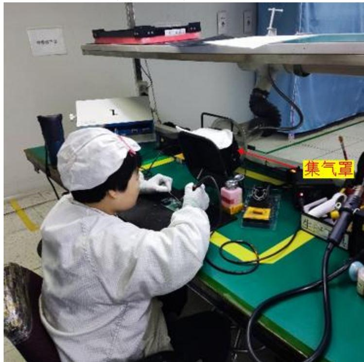
图 7 手工焊设备及集气方式示意图
