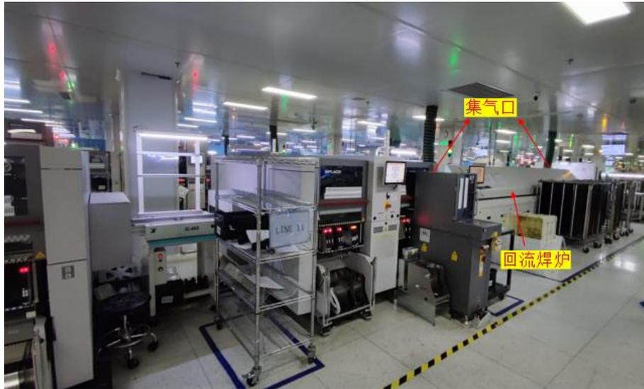
图4 SMT 焊接生产线设备及集气方式示意图
