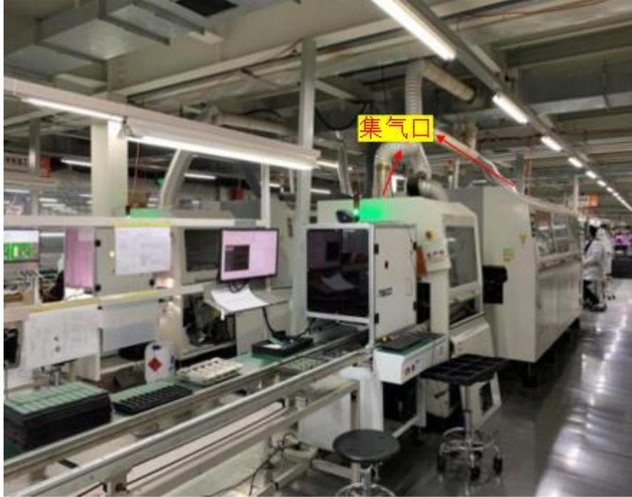
图 6 波峰焊设备及集气方式示意图
