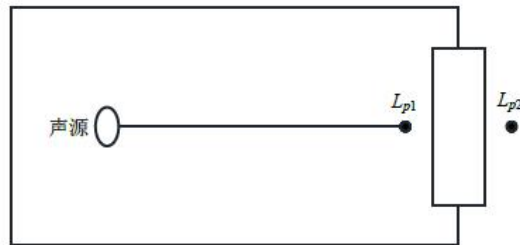
图 4-1 室内声源等效为室外声源图例
