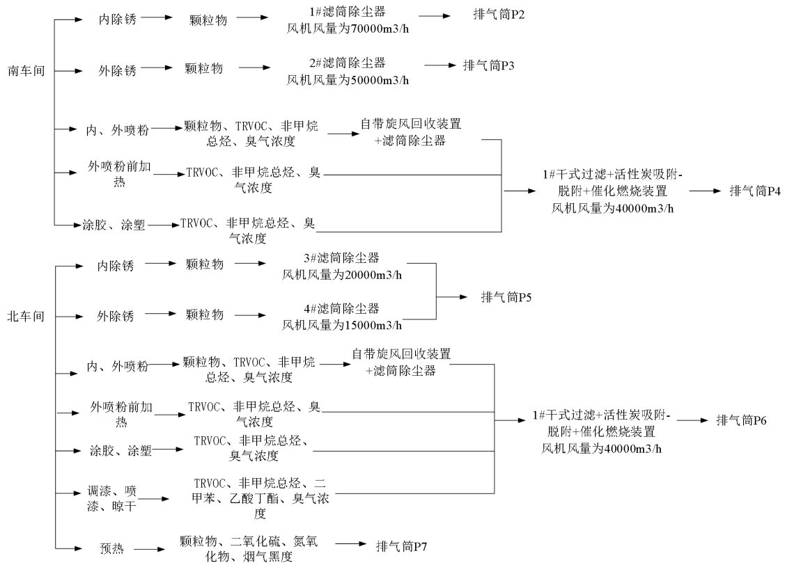
图5 废气收集、处理、排放方案图
