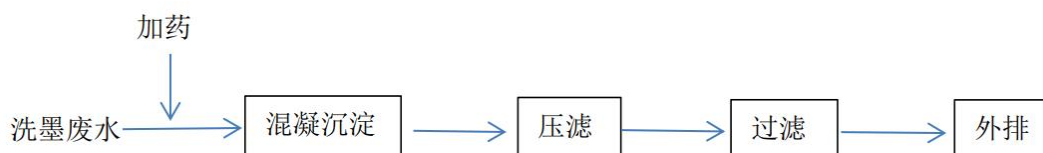
图 2-9 本项目污水处理站工艺流程图
