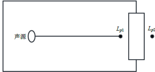
图 5-7 室内声源等效为室外声源图例
